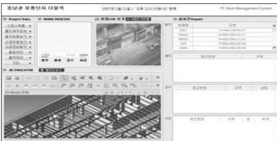
[그림 9] 철골, PC공사의 진행현황이 3D 이미지와 함께 제공되고 있으며, 이 현황은 RFID를 통하여 실시간으로 업데이트되고 있다.
